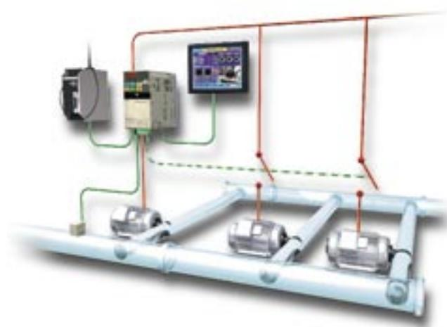
▲ Система последовательного управления насосами
