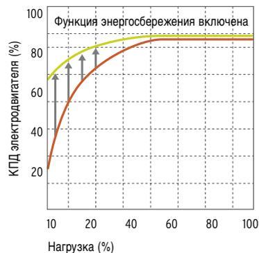
▲ ▼ Функция энергосбережения и повышенный коэффициент мощности снижают затраты на электроэнергию.
