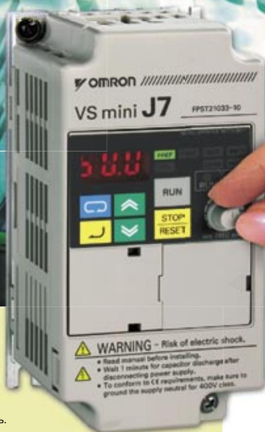
Основными отличительными особенностями приводов серии J7 являются простота и экономичность. Используя управление по соотношению напряжение/частота с функцией оперативной компенсации крутящего момента, этот привод обеспечивает 100% момент даже при частоте 1,5 Гц. Привод J7 снабжен встроенным потенциометром для регулирования скорости, 4 настраиваемыми входами, одним настраиваемым релейным выходом, а также многофункциональным аналоговым выходом.
